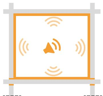
El correcto diseño de los trasdosados y, si es el caso, de los falsos techos permite atenuar cualquier tipo de propagación del ruido y evitar la transmisión del ruido aéreo generado en la habitación.
